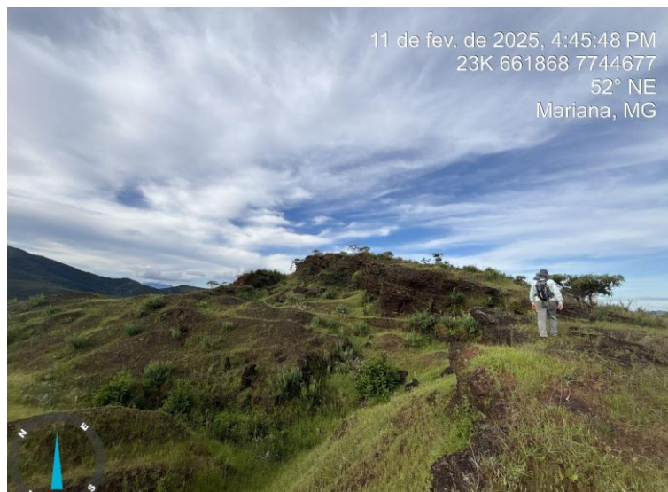
Figura 5 - Ponto identificado na área de estudo. Desmorte hidráulico: Registro de frente de lavra resultante de desmorte hidráulico ( ruina montium ), evidenciando os efeitos da erosão controlada por este processo de extração mineral.
